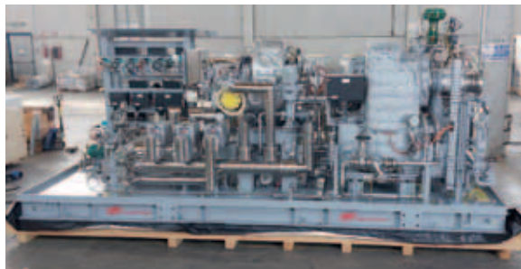
Compressore aria API 672 TA3000 azionato da turbina a vapore.
