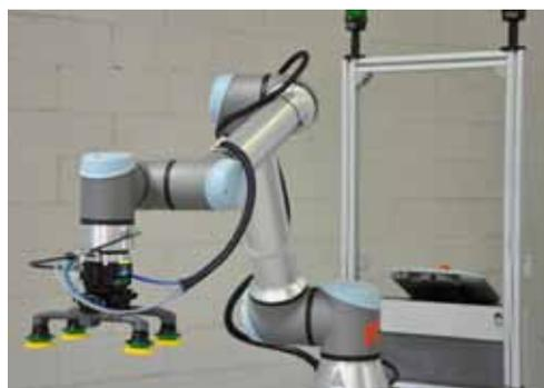
**Il gripper piCOBOT in versione customizzata speciale, con braccio aggiuntivo a 4 ventose, impiegato da Effedi Automation nella cella di pallettizzazione collaborativa Flexipall.**
