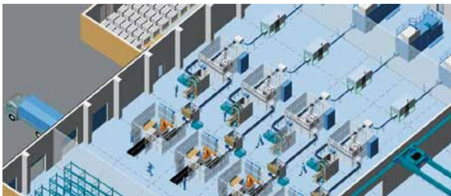
di ventilazione o i percorsi sono stati pianificati senza tener conto di altri dati, questo porta a dover adattare il progetto della fabbrica sul posto. Se la progettazione viene fatta solo in 2D, le collisioni possono essere facilmente trascurate. In cantiere, per esempio, c'è una sovrapposizione imprevista dei percorsi dei nastri trasportatori. Questo porta a un allungamento dei
