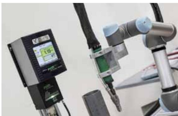
Robot collaborativo con avvitatore autoalimentato elettronico per controlli in process.
