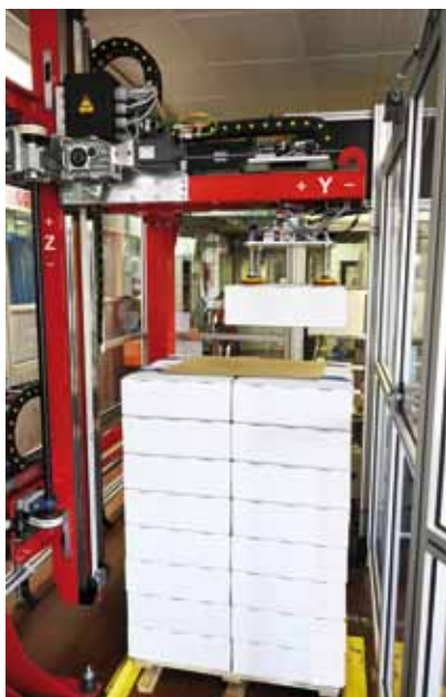
Il gripper con le ventose B75 in silicone e gli eiettori mini COAX di Piab montato nel sistema di pallettizzazione Mini Open di Robotecnik.
