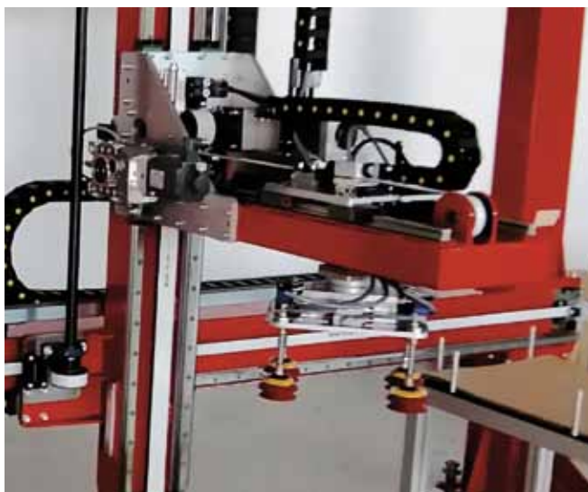
Il sistema di pallettizzazione Mini Open di Robotecnik installato presso Banca d'Italia.
