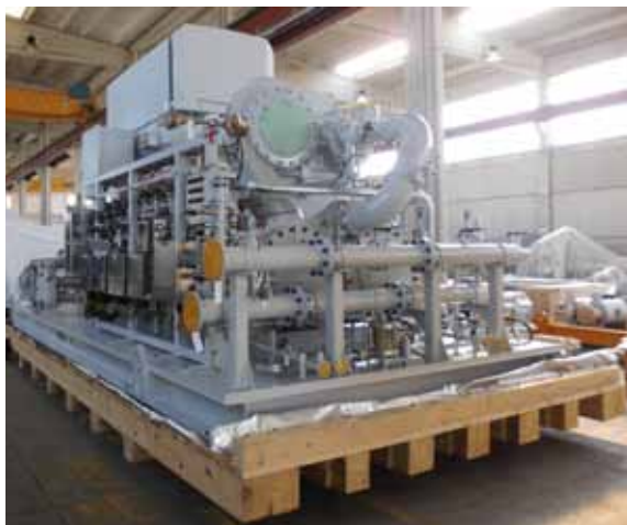
il primo package Turbo-Air NX12000 API672.
