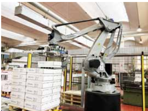
Commessa per Cartiere Fabriano: un sistema di presa flessibile che sfrutta la pneumatica Festo.
