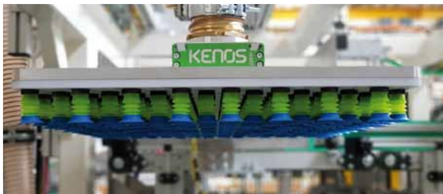
Il sistema a vuoto Kenos KVGL, equipaggiato con ventose piGRIP, installato sull'impianto di incartamento automatico di Selematic.
