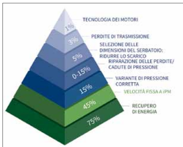
Il recupero di calore è il modo migliore per ridurre i costi energetici con Rollair iPM.
