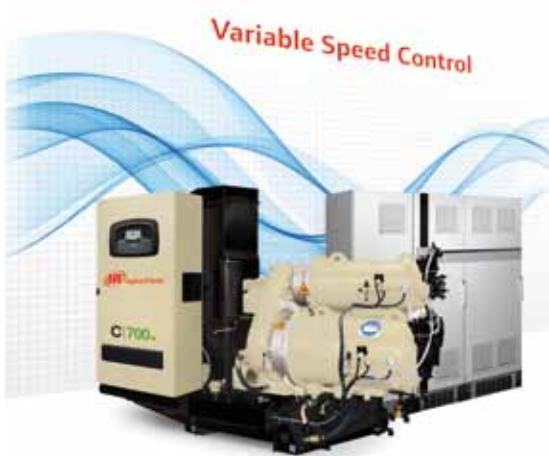
Ingersoll Rand MSG Centac C700n con valvole di aspirazione a palette orientabili su ogni stadio.
