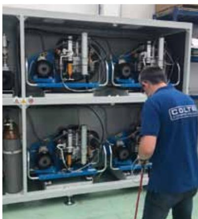
Ingegnere dell'Aerotecnica Coltri in supervisione durante la messa a punto dell'impianto di recupero con compressori per elio.
