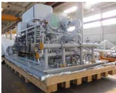
**Prima unità NX12000 API 672 assemblata e testata presso lo stabilimento di Vignate. Macchina da 2 MW per Middle East (Temperatura Ambientale: 50 °C).**
