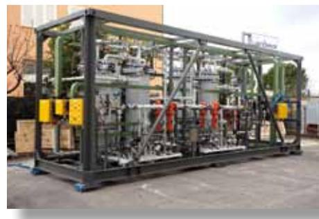
**Generatore di azoto su skid con tecnologia PSA reso completamente ridondante per applicazione Oil&Gas ambiente desertico.**
