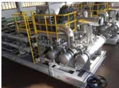
**Compressore CENTAC C950 fornito per raffineria in Kuwait con scambiatori esterni ed azionato da turbina a vapore (Temperatura Ambientale: 50 °C).**
