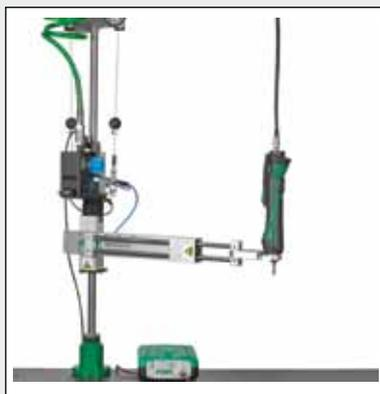
Il braccio è dotato anche di un utile limitatore di corsa verticale regolabile che impedisce alla barra orizzontale di avvicinarsi
