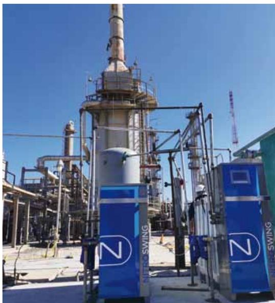
Generatore di azoto tecnologia PSA modulare ed espandibile on site per applicazione raffineria ambiente desertico, heavy duty alte temperature.
