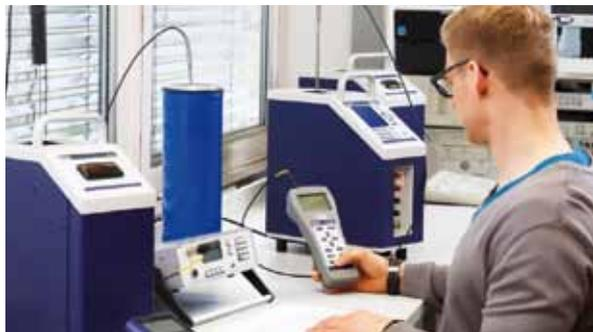
in modo da essere il più stretto possibile, poiché qualsiasi intercapedine d'aria tra la sonda in prova e l'inserito compromette la convezione di calore.
