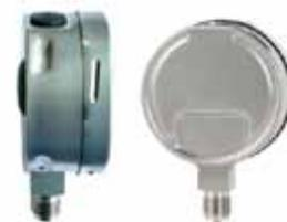
Fig. 2 - La cassa del manometro PG23LT (a destra), a confronto con la versione standard (a sinistra): non sono presenti elastomeri.
