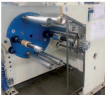
stampaggio di chiusure di garanzia per l'industria enologica, ha portato ancora una volta l'azienda a dotarsi delle soluzioni di pneumatica Aventics per la costruzione di Rotoshaftless 550, una macchina rotocalco adatta alla produzione personalizzata di piccole e medie tirature su minime larghezze di stampa, con cambio lavoro rapido e possibilità di ottenere un prodotto finito senza ulteriori passaggi.
