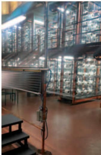
**Cantra del reparto stiro-orditura caricata con le bobine di filo (fino a 1600); il tappeto creato con i fili di ogni bobina subirà poi i processi tecnologici di stiro e interlacciatura con aria compressa.**
