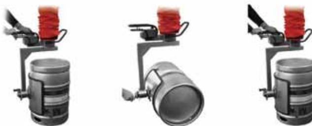
essere capovolti oltre che sollevati per la successiva impilatura: con un sollevatore ergonomico Vaculex, possono essere movimentati da un solo addetto senza alcun rischio di lesioni alla schiena, dovute a sforzi ripetuti, e senza l'ausilio di un carrello elevatore, che a volte, in spazi ridotti, è impossibile utilizzare, migliorando così la qualità del lavoro.
