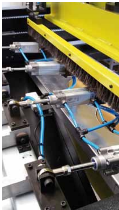
Cilindri, tubi e raccordi Aignep installati su un macchinario Valmart.
