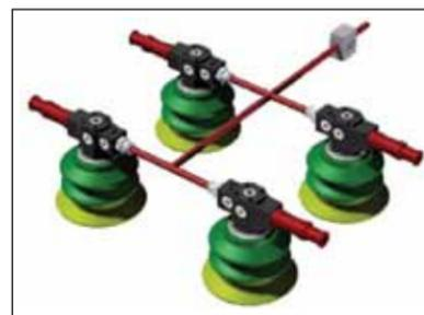
Fig. 1 - Un design del prodotto in cui sono integrate diverse ventose di aspirazione con cartucce di vuoto semplifica la scelta, il dimensionamento e l'installazione di un sistema del vuoto. I vantaggi sono un sistema del vuoto più veloce, conveniente e affidabile.
