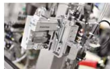
I pezzi vengono prelevati e posizionati per il controllo qualità attraverso le mini slitte MSC Aventics, la nuova generazione di mini slitte con ammor-
