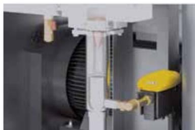
Fig. 5 - Separatore di condensa con scarico.
